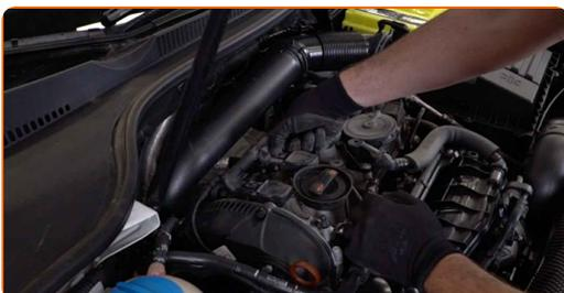
5 Eleve ligeiramente a cablagem das bobinas de ignição e mova para o lado.
