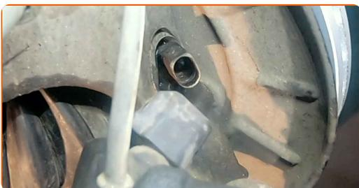
**7** Limpe o elemento fixador do sensor ABS. Use uma escova metálica. Use spray WD-40.
