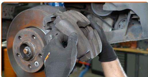
**Substituição: pastilhas de travão – VW Transporter V Camião de plataforma / Chassis (7JD, 7JE, 7JL, 7JY, 7JZ, 7FD). Conselho:**
