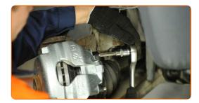
Aperte o elemento de fixação que liga o tubo de freio à pinça do travão. Use uma chave combinada nº 14. Use uma chave de torque. Aperte-o para o torque de 15 Nm.
