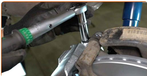
**33** Limpe a sujidade do parafuso da mangueira do travão. Utilize um produto de limpeza para travões.
