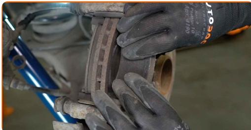
Substituição: pastilhas de travão – VW Transporter V Minibus (7HB, 7HJ, 7EB, 7EJ, 7EF, 7EG, 7HF, 7EC). Conselho de especialistas da AUTODOC:
