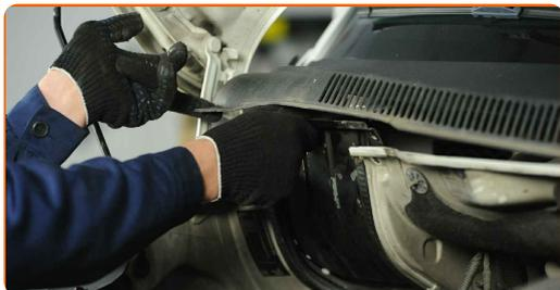
**66** Aperte os parafusos de montagem da cobertura protetora. Use Torx T30. Use uma chave de catraca.
