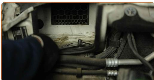
**64** Instale a tampa do apoio da coluna de suspensão.
