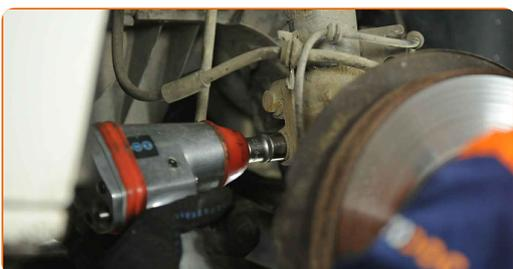
**22** Retire os parafusos de fixação.
