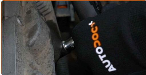
6 Remova a bobina de ignição.
