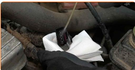
16 Ligue o conector da bobina de ignição.
