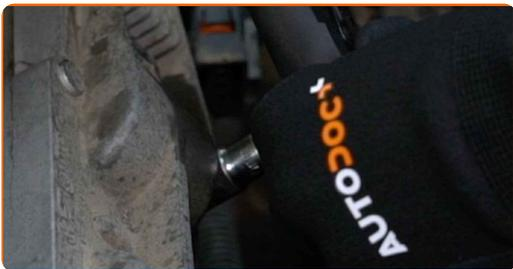
**6** Remova a bobina de ignição.
