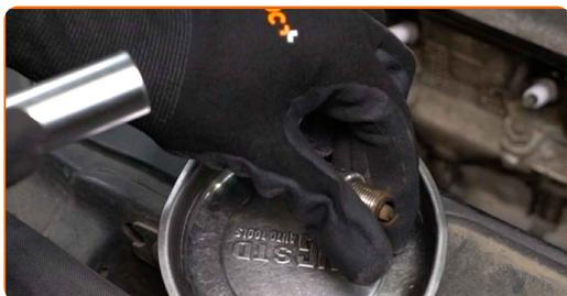
**10** Aplique uma camada fina de um lubrificante antigripante de alta temperatura específico às roscas das novas velas de ignição.
