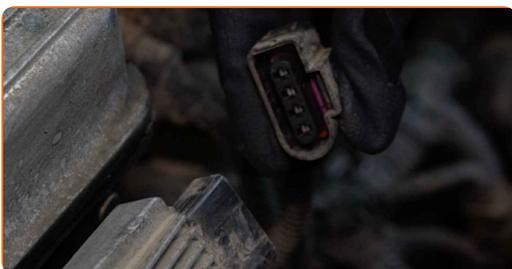
**4** Limpe os parafusos da bobina de ignição. Use uma escova metálica. Use spray WD-40.
