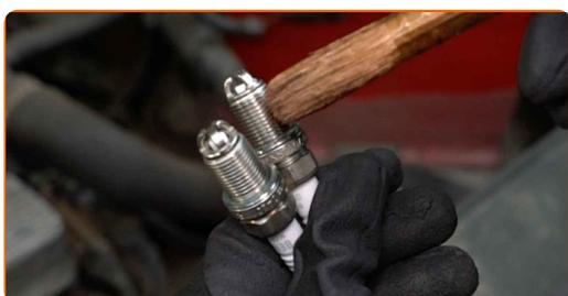
**11** Instale as velas de ignição novas nos seus locais de montagem.
