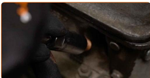
**12** Aparafuse as novas velas de ignição e aperte-as. Use o soquete da vela de ignição #16. Use uma chave de torque. Aperte-o para o torque de 25 Nm.
