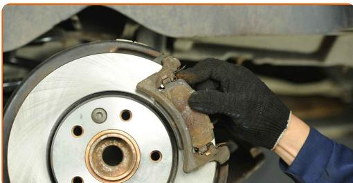
**33** Junte o conector do sensor de desgaste da pastilha de travão.
