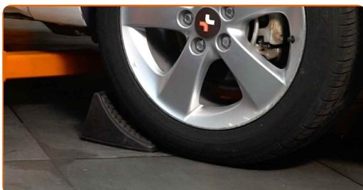
**3** Solte os parafusos de montagem das rodas. Use o soquete de impacto para roda #19.
