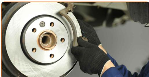
**30** Instale os parafusos de fixação (2 peças).
