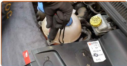
**27** Fixe o conector do tanque de expansão do líquido de arrefecimento.
