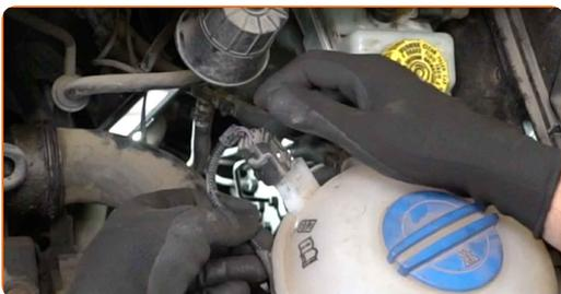
**4** Desparafuse os fixadores do reservatório de refrigeração. Use a chave Phillips.
