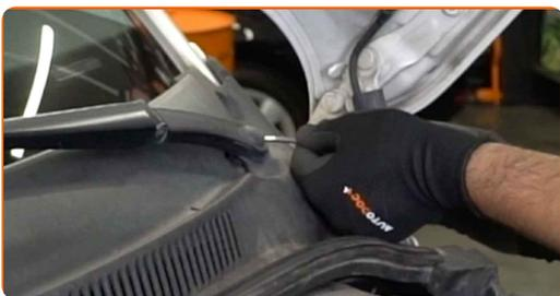
**4** Limpe os fixadores dos braços do limpa-para-brisas. Use uma escova metálica. Use spray WD-40.
