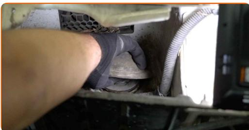
**10** Limpe o fixador superior do suporte do dispositivo amortecedor. Use uma escova metálica. Use spray WD-40.
