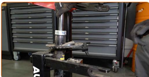
Substituição: kit de suspensão – VW Transporter VI Van (SGA, SGH).
