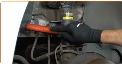
**20** Desaparafuse o fixador que conecta a bieleta da barra estabilizadora à coluna do amortecedor. Use uma chave soquete nº 18. Use uma chave de catraca.
