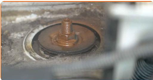
**85** Instale a tampa do apoio da coluna de suspensão.
