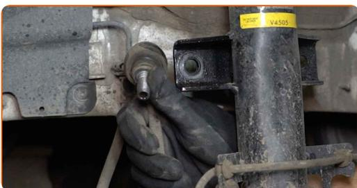
**22** Desligue a instalação elétrica e a mangueira do travão do braço de suporte do amortecedor.
