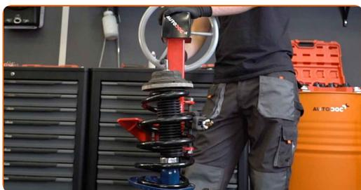
**53** Retire a coluna de suspensão montada.
