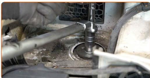
**84** Trate o fixador superior do suporte de suspensão. Use massa de cobre.
