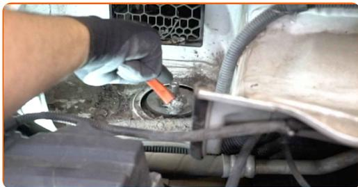
**11** Solte o fixador superior do apoio da coluna de suspensão. Use HEX n.º H7. Use uma chave soquete n.º 21. Use uma chave de catraca.
