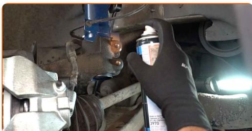
**76** Trate a superfície onde o disco de travão entra em contacto com o aro da roda. Use massa de cobre.
