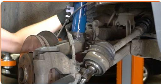
**60** Instale os parafusos de fixação.
