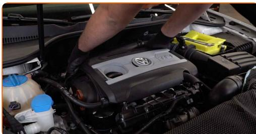
4 Desconecte os conectores das bobinas de ignição.
