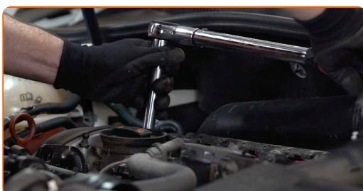
**Substituição: vela de ignição – VW Transporter VI Van (SGA, SGH). AUTODOC recomenda:**
