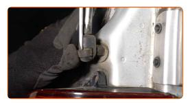
Solte o anel de retenção que liga o amortecedor à tampa da bagageira. Use uma chave de fenda plana.
