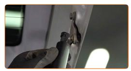
Encaixe o anel de retenção que liga o amortecedor da bagageira à carroçaria do automóvel. Use uma chave de fenda plana.
