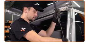
Instale o novo amortecedor de gás da tampa da bagageira. 6
