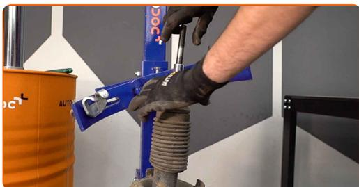
**37** Retire o amortecedor antigo do compressor hidráulico de mola.
