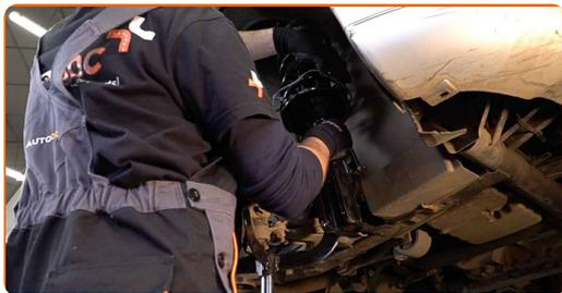
**47** Aparafuse a fixação superior de montagem do suporte do amortecedor. Não o aperte.
