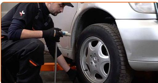
**14** Solte os parafusos de montagem das rodas. Use o soquete de impacto para roda #17.
