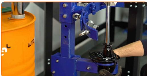
**39** Instale a manga para poeiras e a bomba de bloqueio no novo amortecedor.
