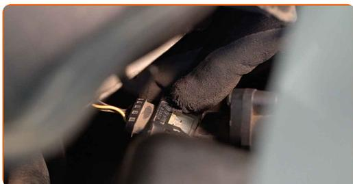
**68** Aparafuse os fixadores da válvula conversora de pressão de vácuo.
