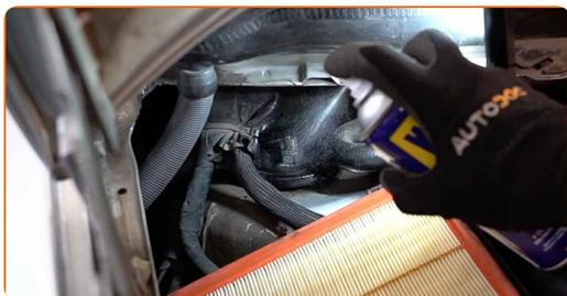
**12** Solte o fixador superior do apoio da coluna de suspensão. Use uma chave combinada nº 21. Use HEX n.º H6.
