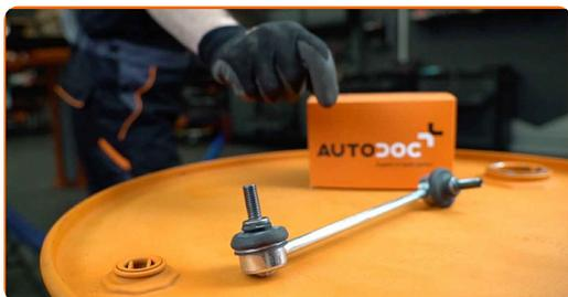
**11** Desparafuse o fixador que conecta bieleta da barra estabilizadora à barra estabilizadora. Use uma chave soquete nº 16. Use uma chave combinada nº 16. Use uma chave de torque. Aperte-o para o torque de 62 Nm.
