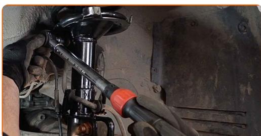
**12** Aperte o fixador que conecta a bieleta da barra estabilizadora à barra estabilizadora. Use uma chave soquete nº 16. Use uma chave combinada nº 16. Use uma chave de torque. Aperte-o para o torque de 62 Nm.
