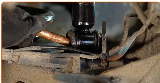
**18** Aparafuse o fixador inferior do amortecedor. Use uma chave soquete nº 21.
