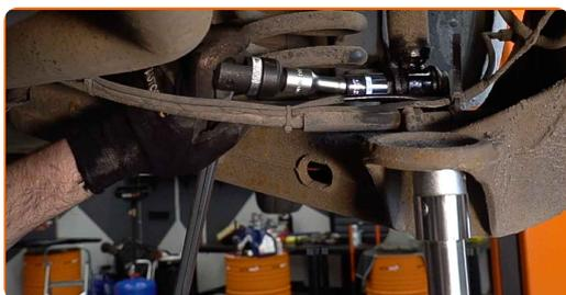
**9** Remova o parafuso de fixação.
