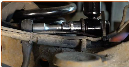
**19** Apoie o eixo de torção da suspensão traseira. Use um macaco hidráulico de caixa de transmissão.
