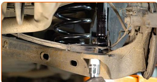
**20** Aperte a fixação inferior do amortecedor. Use uma chave soquete nº 21. Use uma chave de torque. Aperte-o para o torque de 133 Nm.
