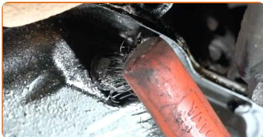
**8** Desaperte o bujão de drenagem. Use uma chave soquete nº 14. Use uma chave de catraca.
