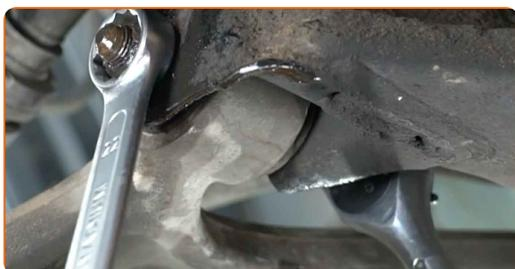
**14** Desaparafuse os fixadores traseiros do braço. Use uma chave soquete nº 19. Use uma chave de catraca.
