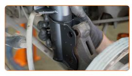
Instale os parafusos de fixação.
