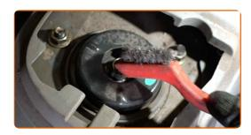
Solte a porca da haste da suspensão. Não a desenrosque por completo. Use uma chave soquete nº 17. Use uma chave de catraca.
