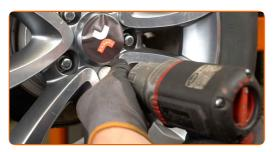
Baixar o carro e trabalhar em ordem transversal, apertar os parafusos das rodas. Use o soquete de impacto para roda #21. Use uma chave de torque. Aperte-o para o torque de 118 Nm.
