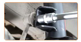
Aplique produto no fixador que liga a biela da barra estabilizadora à torre de suspensão. Trate os fixadores do amortecedor. Use massa de cobre.
