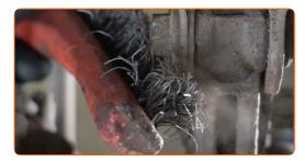
Desaparafuse o elemento fixador, que liga o braço de suspensão à manga de eixo traseira. Use uma chave combinada nº 17. Use uma chave soquete nº 19. Use uma chave de catraca.
