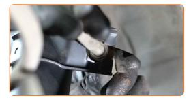
Instale o clipe de retenção da mangueira de travão. Use um martelo.
