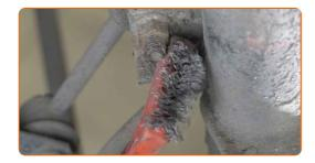
Desaparafuse o fixador que conecta a bieleta da barra estabilizadora à coluna do amortecedor. Use uma chave soquete nº 14. Use uma chave de catraca.
