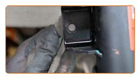
Desaparafuse o fixador que conecta bieleta da barra estabilizadora à barra estabilizadora. Use uma chave soquete nº 14. Use uma chave de torque. Aperte-o para o torque de 42 Nm.
