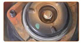
Retire a coluna de suspensão montada.
