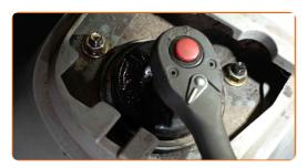
Solte os fixadores superiores do dispositivo amortecedor. Use uma chave soquete nº 14. Use uma chave de catraca.
