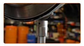
Desaperte os fixadores superiores da coluna de suspensão.
