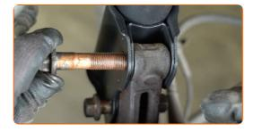
Prenda os fixadores superiores do amortecedor. Use uma chave soquete nº 14. Use uma chave de catraca. Não o aperte.
