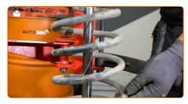
Retire o amortecedor antigo do compressor hidráulico de mola.
