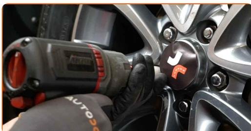
**22** Baixar o carro e trabalhar em ordem transversal, apertar os parafusos das rodas. Use o soquete de impacto para roda #21. Use uma chave de torque. Aperte-o para o torque de 118 Nm.
