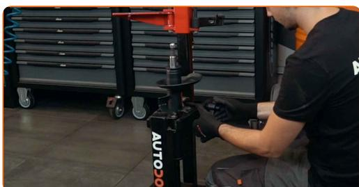
**37** Instale a manga para poeiras e a bomba de bloqueio no novo amortecedor.
