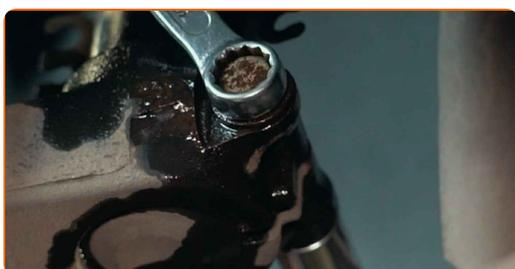
**17** Remova o parafuso de fixação.
