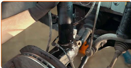
**51** Instale o parafuso de fixação.
