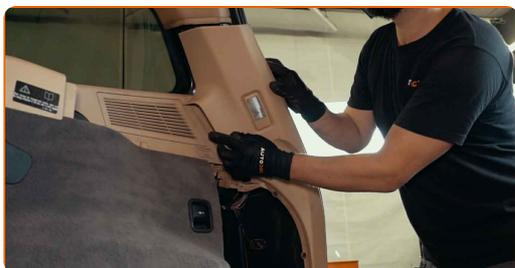
**78** Aparafuse os fixadores da cobertura de plástico da carroçaria do veículo. Use a chave Phillips.
