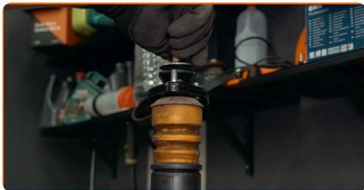
**44** Aperte a porca da haste do amortecedor. Use uma chave combinada nº 17. Utilize a chave para amortecedor NºDD6. Use uma chave inglesa. Use uma chave de torque. Aperte-o para o torque de 14 Nm.
