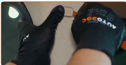
**16** Desaparafuse o fixador do painel de revestimento do pilar da carroçaria. Use Torx T20. Use uma chave de catraca.
