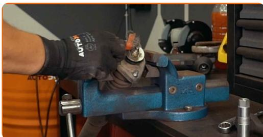
**41** Retire a fixação da haste do pistão do amortecedor. Utilize a chave para amortecedor DDNº6. Use uma chave soquete nº 16. Use uma chave de catraca.
