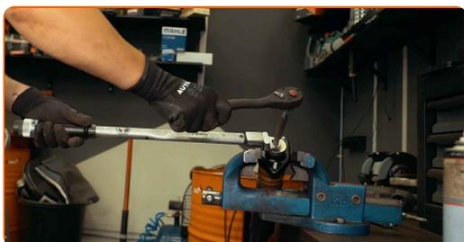
**45** Trate do elemento fixador da haste do amortecedor. Use massa de cobre.
