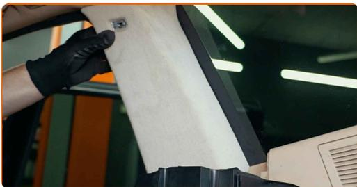
**71** Aparafuse o fixador do painel de revestimento do pilar da carroçaria. Use Torx T20. Use uma chave de catraca.
