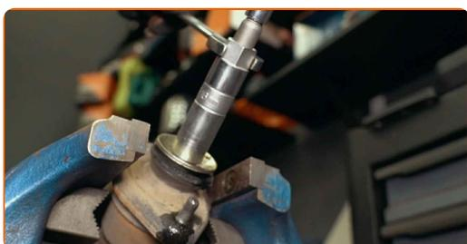
**42** Remova o apoio da coluna de suspensão.
