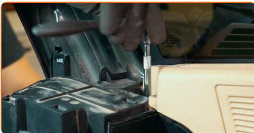
**69** Aperte os fixadores do painel de acabamento plástico lateral. Use uma chave soquete nº 10. Use uma chave de catraca.
