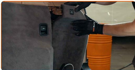
**81** Coloque o revestimento inferior do compartimento de carga.
