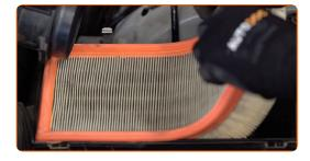
Antes de limpar a tampa e a caixa do filtro de ar, cubra as partes do tubo de ventilação, o sensor de fluxo de massa de ar (se disponível), a válvula do acelerador com um pano limpo.
