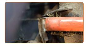
Desaparafuse o elemento de fixação inferior que liga a coluna de suspensão às mangas de eixo. Use uma chave combinada nº 22. Use uma chave soquete nº 22. Use uma chave de catraca.
