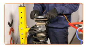
Aperte a porca do suporte do amortecedor da haste do pistão. Use uma chave combinada nº 22. Use HEX n.º H7. Use uma chave de torque. Aperte-o para o torque de 60 Nm.
