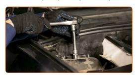
41.1 Instale o tanque do limpa para-brisas e aperte os parafusos.
