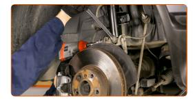
Remova o parafuso de fixação.
