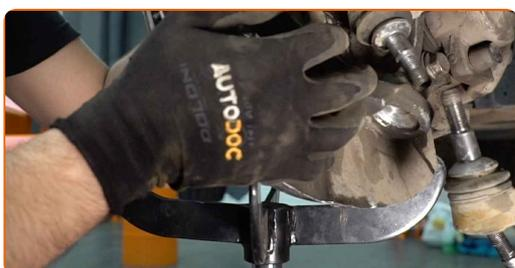
**43** Instale o parafuso de fixação.
