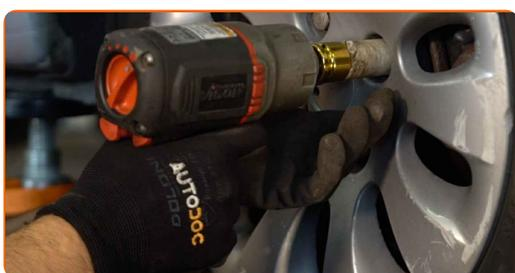
**32** Baixar o carro e trabalhar em ordem transversal, apertar os parafusos das rodas. Use uma chave de torque. Aperte-o para o torque de 100 Nm.
