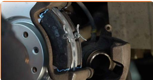
**27** Instale a pinça do travão e fixe-o. Use uma chave combinada nº 13. Use uma chave combinada nº 15. Use uma chave de torque. Aperte-o para o torque de 27 Nm.
