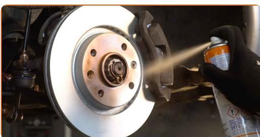
**29** Limpe a superfície do disco de travão. Utilize um produto de limpeza para travões.
