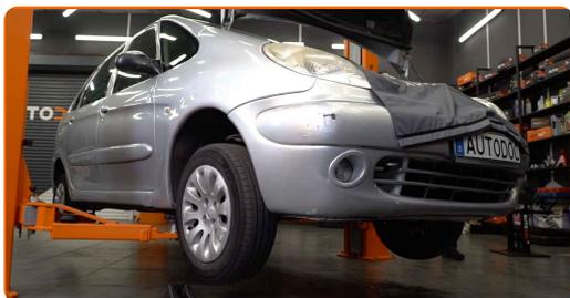
**5** Desaperte os parafusos da roda.
