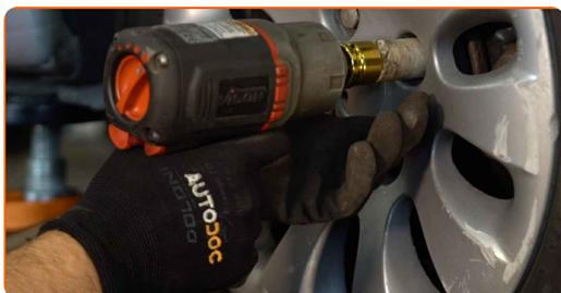
**22** Baixar o carro e trabalhar em ordem transversal, apertar os parafusos das rodas. Use uma chave de torque. Aperte-o para o torque de 100 Nm.
