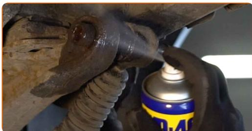
**12** Retire os parafusos de fixação. Use um saca-pino. Use um martelo.
