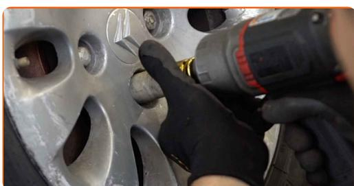
**26** Baixar o carro e trabalhar em ordem transversal, apertar os parafusos das rodas. Use uma chave de torque. Aperte-o para o torque de 100 Nm.
