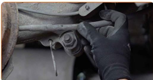
**8** Desaperte a fixação inferior do amortecedor. Use uma chave soquete nº 24. Use uma chave combinada nº 24.
