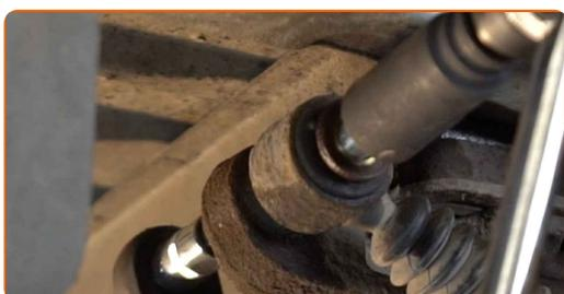
**10** Apoie o eixo de torção da suspensão traseira. Use um macaco hidráulico de caixa de transmissão.
