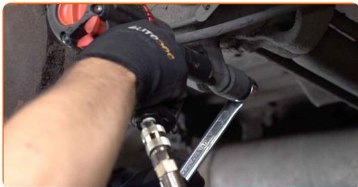
**9** Desaperte a fixação superior do amortecedor. Use uma chave soquete nº 24. Use HEX n.º H14 Use uma chave de catraca. Use uma chave de tarraxa.
