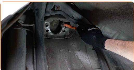
**31** Instale o amortecedor no arco da roda.
