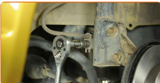
**8** Remova o apoio do suporte do amortecedor.
