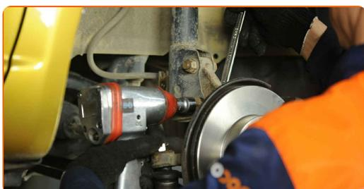
**40** Trate os fixadores do amortecedor. Use massa de cobre.
