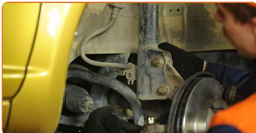
**42** Aperte o suporte de fixação da mangueira do travão do amortecedor. Use uma chave soquete nº 14. Use uma chave de catraca.
