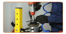
Remova a montagem do suporte superior. Use uma chave de fenda plana.
