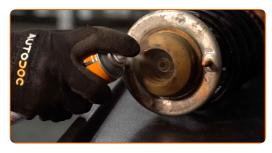
Instale a tampa de proteção do suporte do amortecedor.
