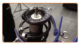
Aperte a porca do suporte do amortecedor da haste do pistão. Use uma chave soquete nº 17. Use uma chave de torque. Aperte-o para o torque de 33 Nm.
