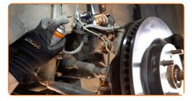
Instale o apoio no suporte do amortecedor.
