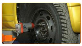
Baixar o carro e trabalhar em ordem transversal, apertar os parafusos das rodas. Use o soquete de impacto para roda #21. Use uma chave de torque. Aperte-o para o torque de 103 Nm.
