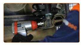
Remova o apoio sob a viga do eixo traseiro.
