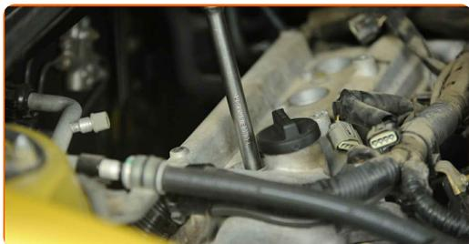
**10** Retire as velas de ignição. Use o soquete da vela de ignição #16.
