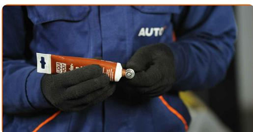
**12** Instale as velas de ignição novas nos seus locais de montagem.
