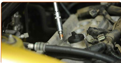
**13** Aparafuse as novas velas de ignição e aperte-as. Use o soquete da vela de ignição #16. Use uma chave de torque. Aperte-o para o torque de 22 Nm.
