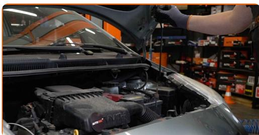
**2** Use uma cobertura de proteção para prevenir a danificação da pintura e das peças plásticas do automóvel.
