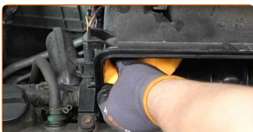
**6** Remova o elemento filtrante da tampa do filtro do ar.
