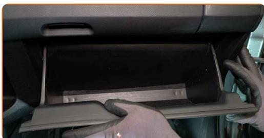
**10** Pressione as paredes laterais do porta-luvas para voltar a montar as travas.
