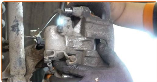
**29** Aperte os fixadores da pinça do travão. Use HEX n.º H7. Use uma chave de torque. Aperte-o para o torque de 28 Nm.
