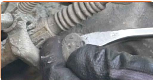
**9** Desaperte os parafusos da pinça de travão. Use HEX n.º H7. Use uma chave de catraca.
