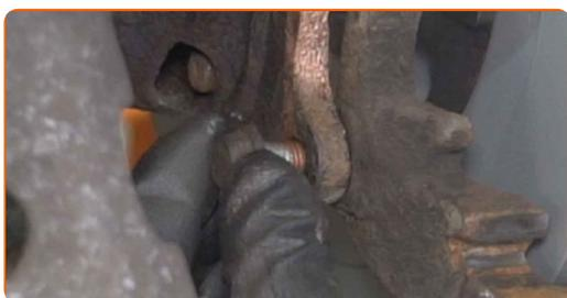
**23** Aperte os parafusos do suporte da pinça do travão. Use uma chave soquete nº 14. Use uma chave de torque. Aperte-o para o torque de 57 Nm.
