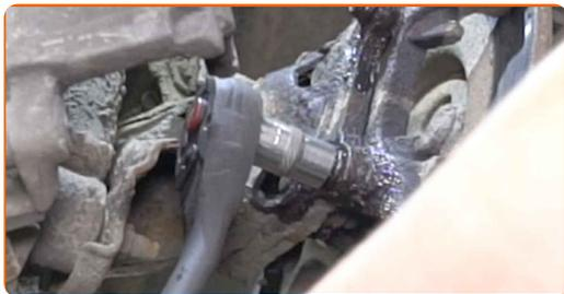
**14** Retire os parafusos de fixação.
