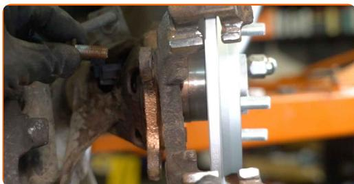
**22** Instale os parafusos de fixação.
