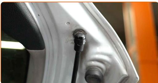
**13** Instale o novo amortecedor de gás da tampa da bagageira.
