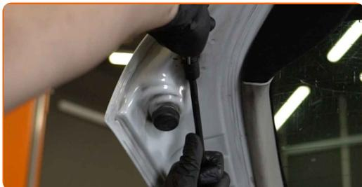
**7** Solte o anel de retenção que liga o amortecedor a gás à carroçaria do automóvel. Use uma chave de fenda plana.
