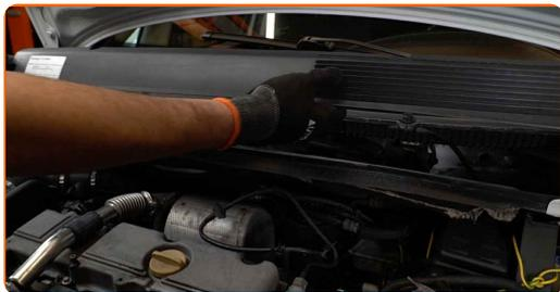
**5** Limpe os fixadores da parte inferior do painel frontal. Use spray WD-40.
