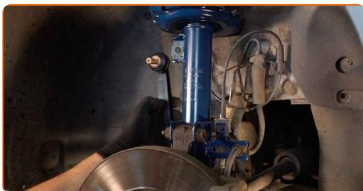
**12** Aperte o fixador que conecta a bieleta da barra estabilizadora à barra estabilizadora. Use uma chave soquete nº 19. Use uma chave de torque. Aperte-o para o torque de 55 Nm.
