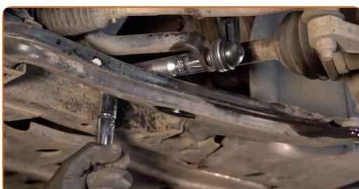
**13** Desaparafuse o fixador que conecta bieleta da barra estabilizadora à barra estabilizadora. Use uma chave soquete nº 19. Use uma chave de torque. Aperte-o para o torque de 55 Nm.
