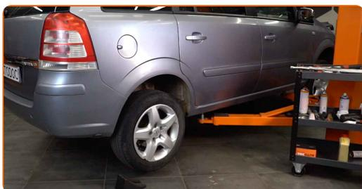
**4** Desaperte os parafusos da roda.
