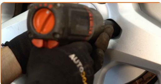
**28** Baixar o carro e trabalhar em ordem transversal, apertar os parafusos das rodas. Use uma chave de torque. Aperte-o para o torque de 110 Nm.
