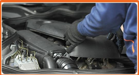
Instale a tampa do motor e fixe-a.
