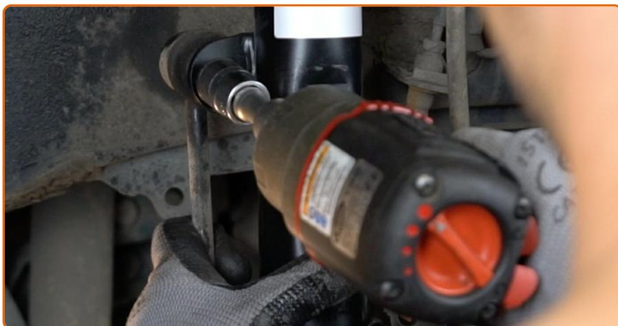
Desaparafuse o fixador que conecta bieleta da barra estabilizadora à barra estabilizadora. Use uma chave soquete nº 17. Use uma chave de torque. Aperte-o para o torque de 50 Nm.
