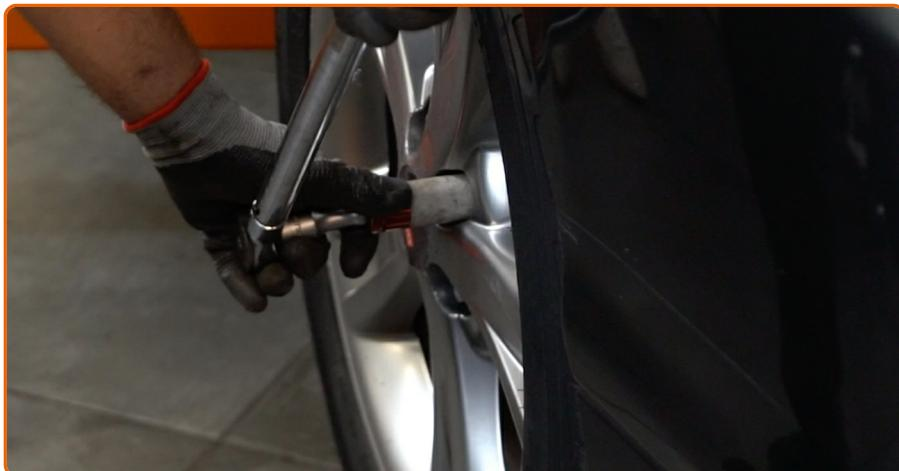
Baixar o carro e trabalhar em ordem transversal, apertar os parafusos das rodas. Use o soquete de impacto para roda #21. Use uma chave de torque. Aperte-o para o torque de 120 Nm.
