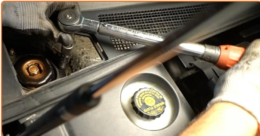
Aperte a fixação superior da montagem do suporte do amortecedor. Use uma chave soquete nº 14. Use uma chave de torque. Aperte-o para o torque de 50 Nm.
