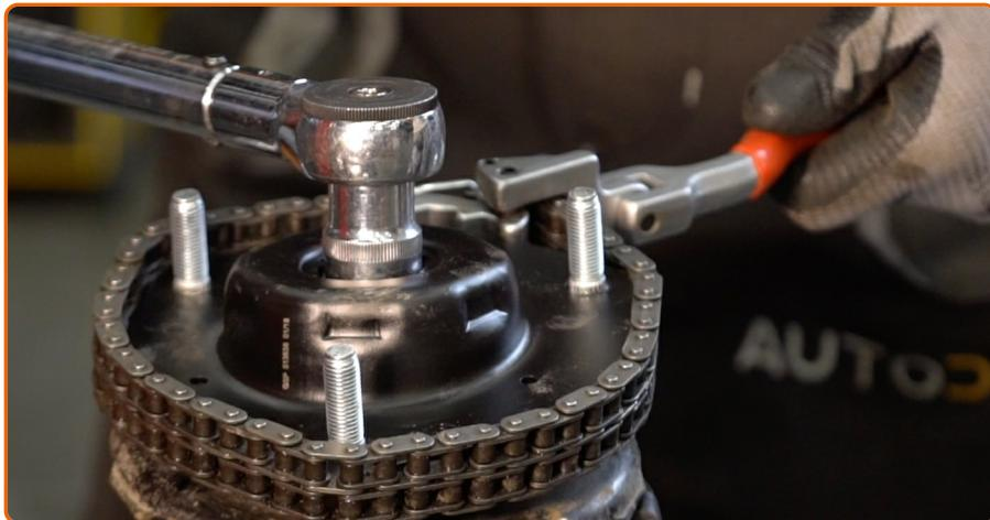
Aperte a porca do suporte do amortecedor da haste do pistão. Use uma chave soquete nº 21. Utilize a chave de corrente. Use uma chave de torque. Aperte-o para o torque de 60 Nm.
