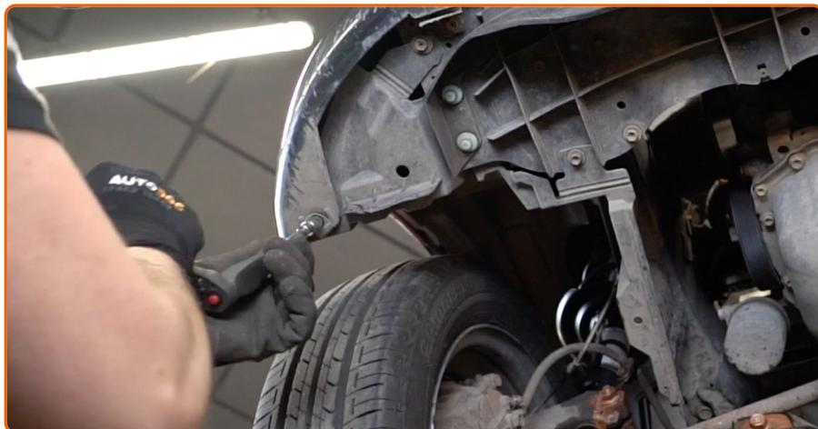
Desaparafuse o elemento fixador inferior do para-choques. Use uma chave soquete nº 10. Use uma chave de catraca.
