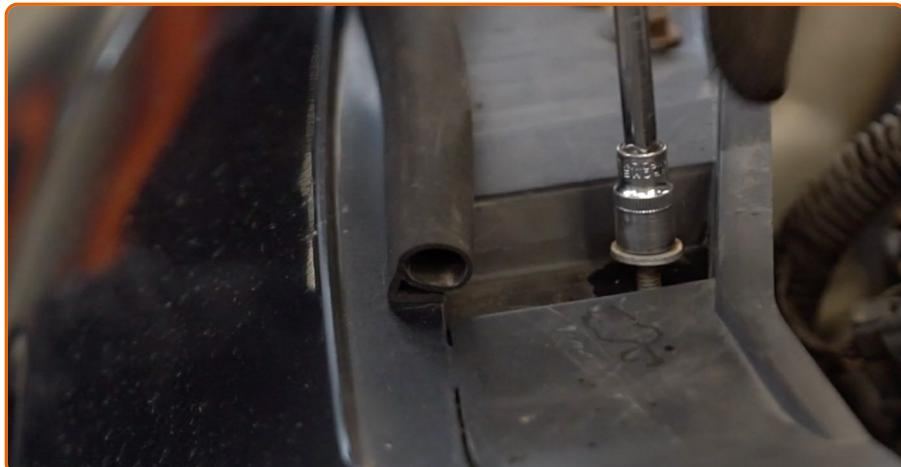
Aparafuse os fixadores superiores do para-choque. Use uma chave soquete nº 10. Use uma chave de catraca.
