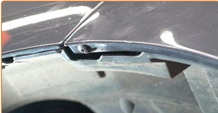
Aparafuse o elemento fixador lateral do para-choques. Use a chave Phillips.
