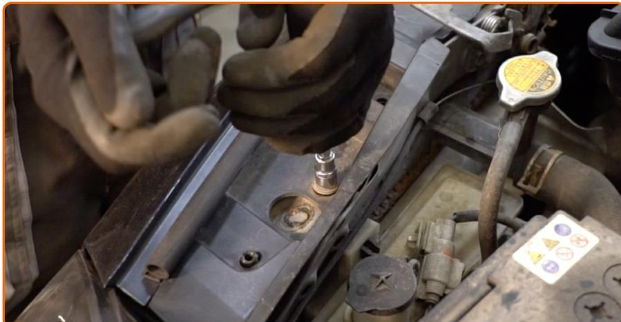
Desaparafuse o elemento fixador superior do para-choques. Use uma chave soquete nº 10. Use uma chave de catraca.
