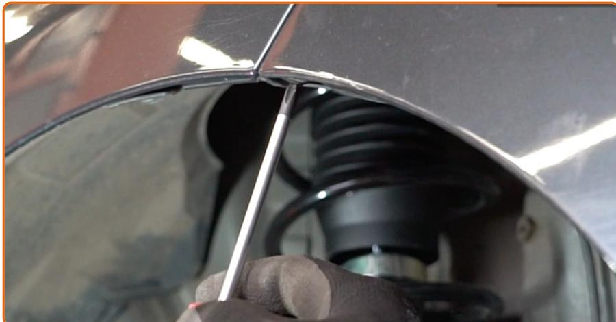
Desaparafuse o elemento fixador lateral do para-choques. Use a chave Phillips.
