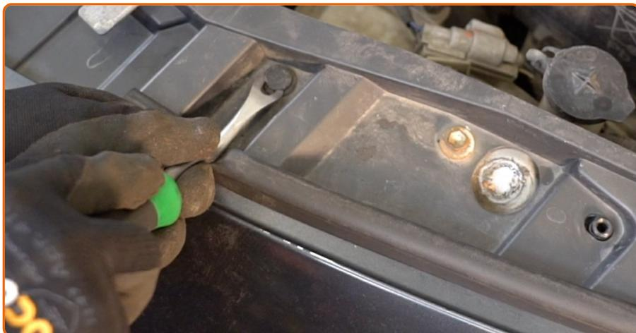
Remova os clipe do para-choque. Use uma ferramenta de remoção de clipe.
