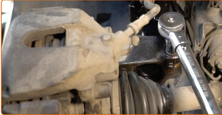
Aperte os fixadores inferiores que conectam a coluna de suspensão à manga de eixo. Use uma chave soquete nº 15. Use uma chave de torque. Aperte-o para o torque de 80 Nm.
