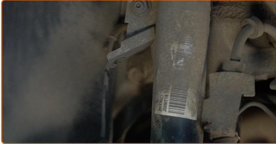
Desconecte a fixação do cabo do sensor ABS.
