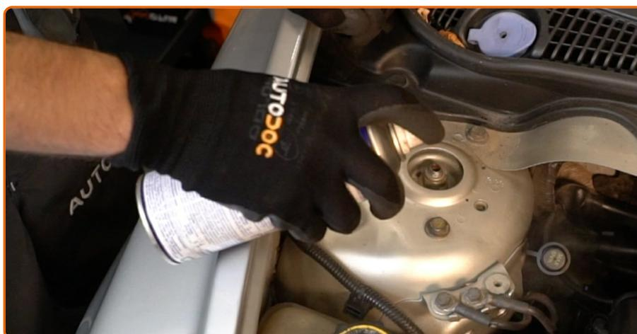
Limpe os fixadores da montagem superior do suporte do amortecedor. Use spray WD-40.
