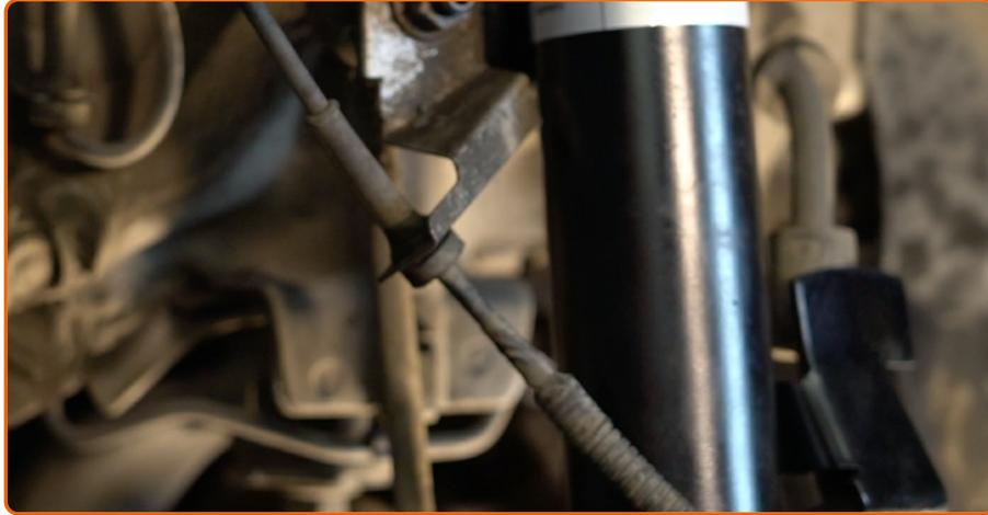
Conecte a fixação do cabo do sensor ABS ao suporte do amortecedor.
