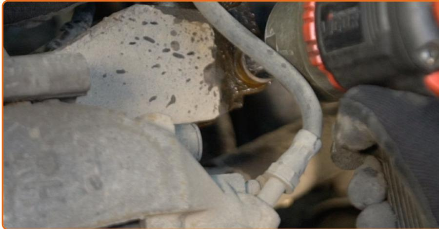
Desparafuse o elemento de fixação inferior que liga a coluna de suspensão às mangas de eixo. Use uma chave soquete nº 15. Use uma chave de catraca. Use uma chave de tarraxa.
