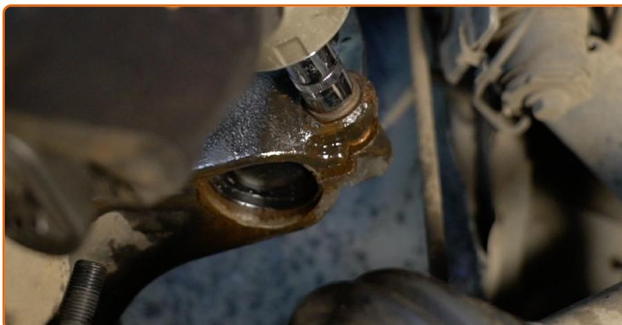
Instale o parafuso de fixação. Use uma chave soquete nº 15.
