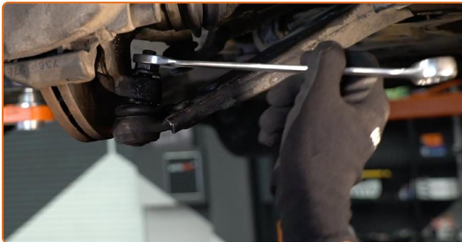
Aperte o fixador da articulação esférica. Use uma chave combinada nº 21. Use uma chave de torque. Aperte-o para o torque de 60 Nm.
