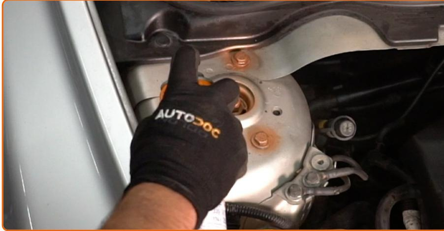
Trate os fixadores do amortecedor. Trate a haste da coluna do amortecedor. Use massa de cobre.
