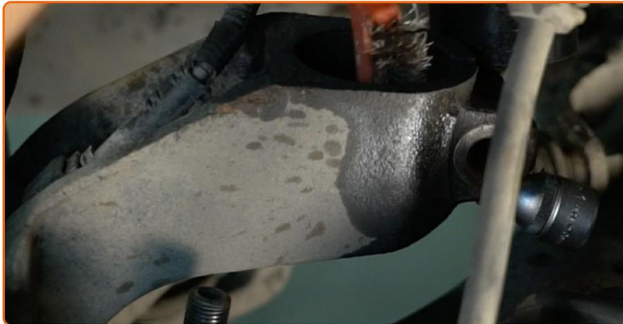
Trate o assento de montagem da coluna de suspensão na manga de eixo. Use uma escova metálica. Use spray WD-40.
