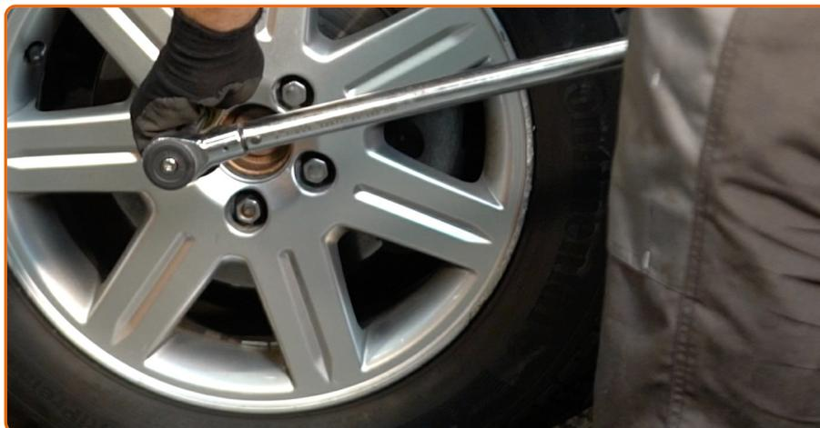
Apertar os parafusos da roda usando um padrão cruzado. Use uma chave de torque. Aperte-o para o torque de 120 Nm.
