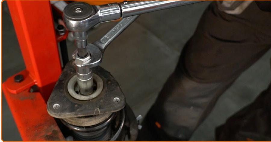
Aperte a porca do suporte do amortecedor da haste do pistão. Use HEX n.º H6 Use uma chave soquete nº 18. Use uma chave de torque. Aperte-o para o torque de 55 Nm.
