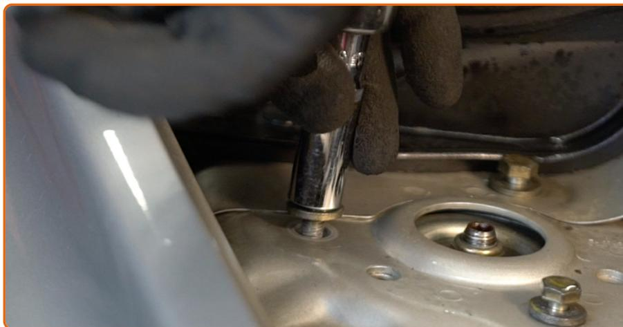
Solte o fixador superior do apoio da coluna de suspensão. Use uma chave soquete nº 13. Use uma chave de catraca.
