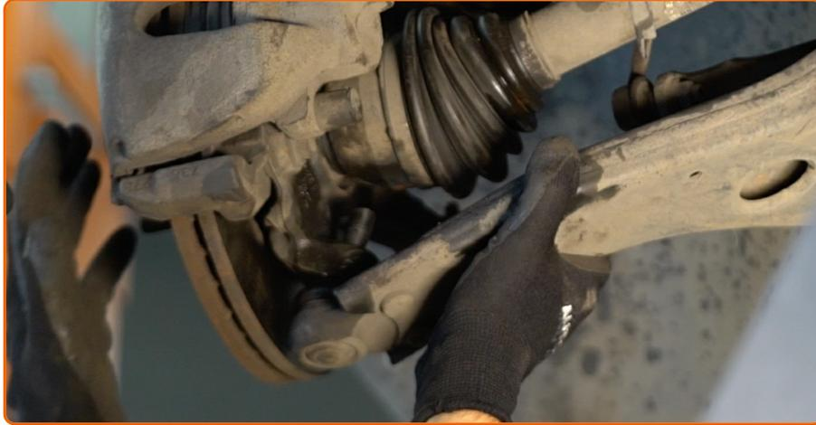
Conecte a articulação esférica à manga de eixo. Conecte o braço inferior à manga de eixo.
