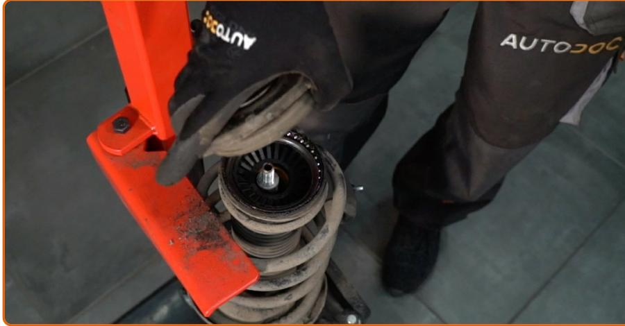
Remover a parte superior do suporte do amortecedor em conjunto com a base do rolamento.
