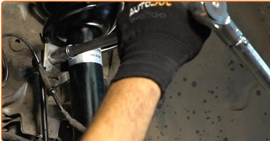
Desparafuse o fixador que conecta bieleta da barra estabilizadora à barra estabilizadora. Use uma chave combinada nº 15. Use HEX n.º H5 Use uma chave de torque. Aperte-o para o torque de 65 Nm.
