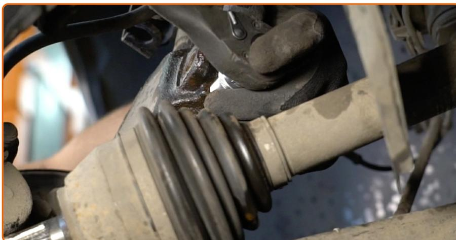
Solte o fixador inferior que conecta a coluna de suspensão às mangas de eixo. Use uma chave especial para remover o amortecedor. Use uma chave de catraca.
