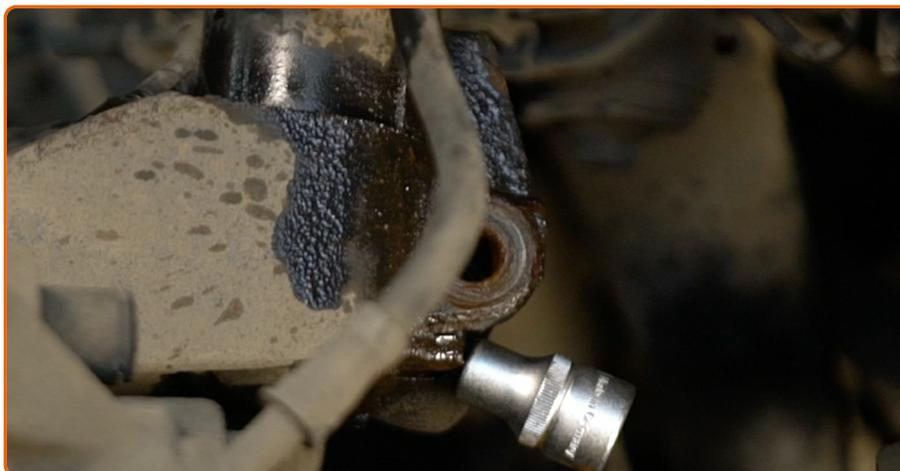
Remova o parafuso de fixação.
