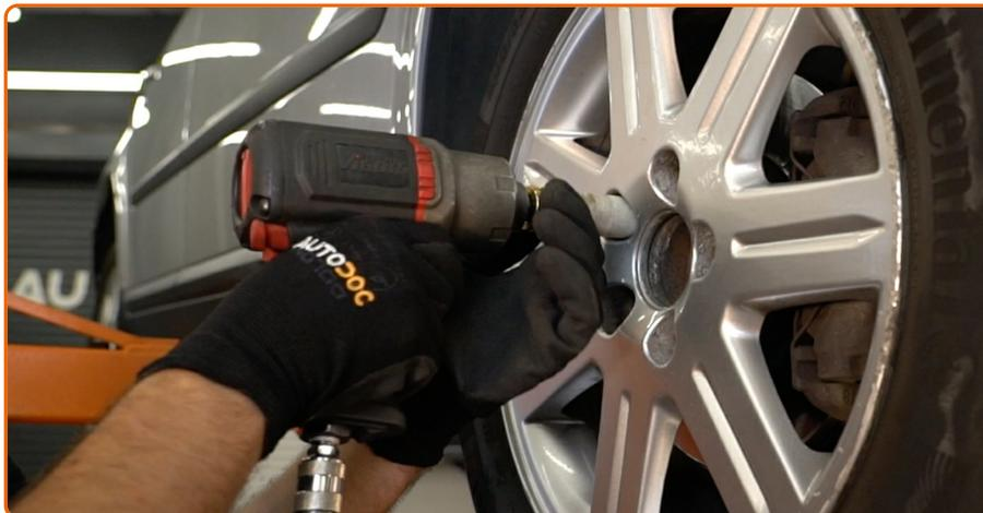
Desaperte os parafusos da roda.
