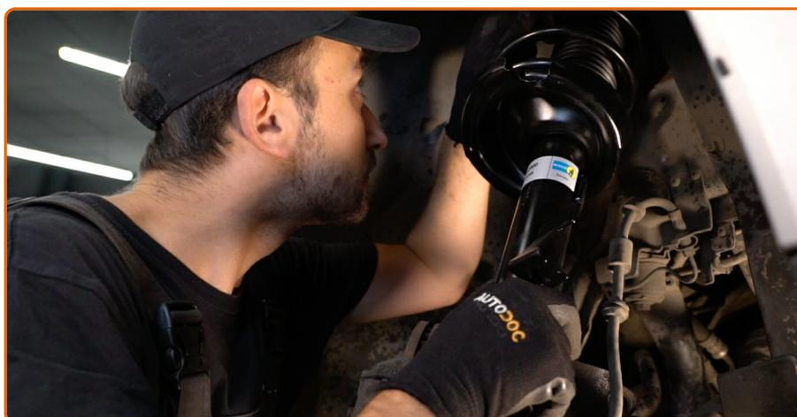
Instale o amortecedor no arco da roda.
