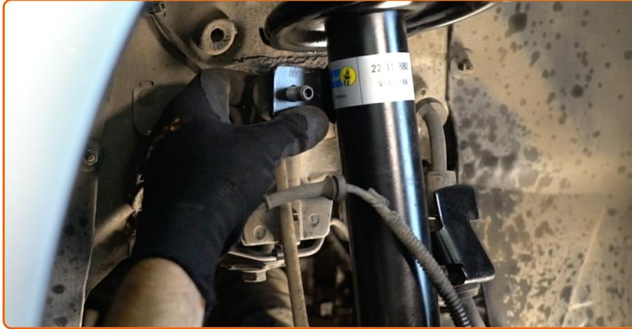
Instale o terminal do estabilizador transversal.
