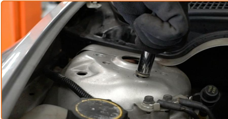
Desapertar a fixação superior de montagem do suporte do amortecedor.
