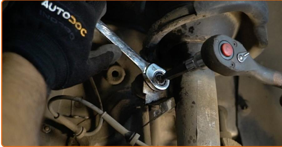
Desparafuse o fixador que conecta a bieleta da barra estabilizadora à coluna do amortecedor. Use uma chave combinada n° 15. Use HEX n.º H5 Use uma chave de catraca.
