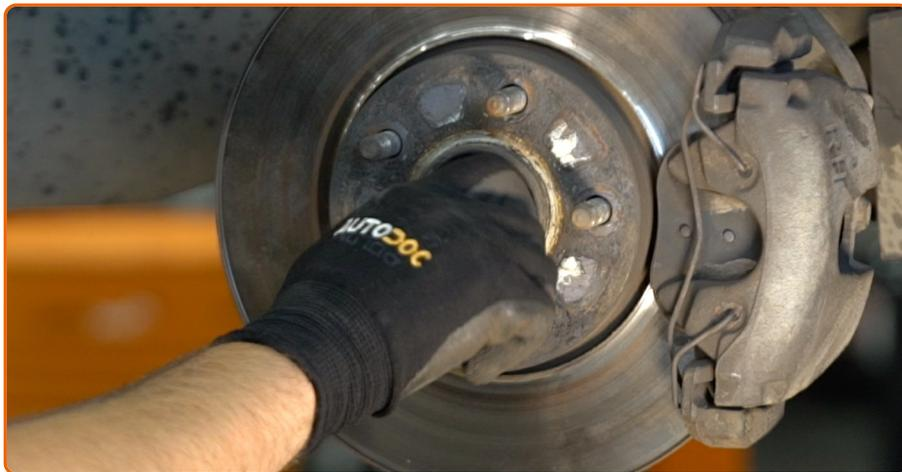
Instale e aperte o parafuso do eixo de transmissão. Use uma chave soquete nº 13.
