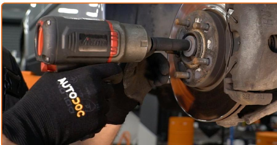
Remova o parafuso de fixação.
