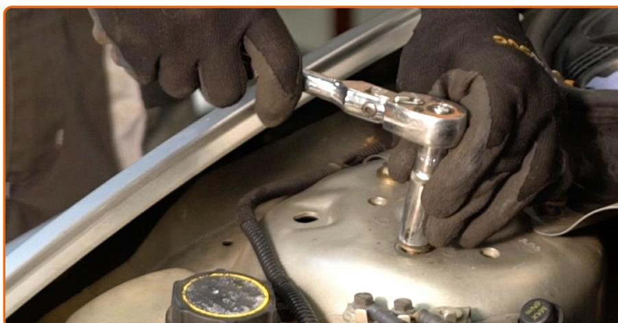
Aperte a fixação superior da montagem do suporte do amortecedor. Use uma chave soquete nº 13. Use uma chave de torque. Aperte-o para o torque de 35 Nm.
