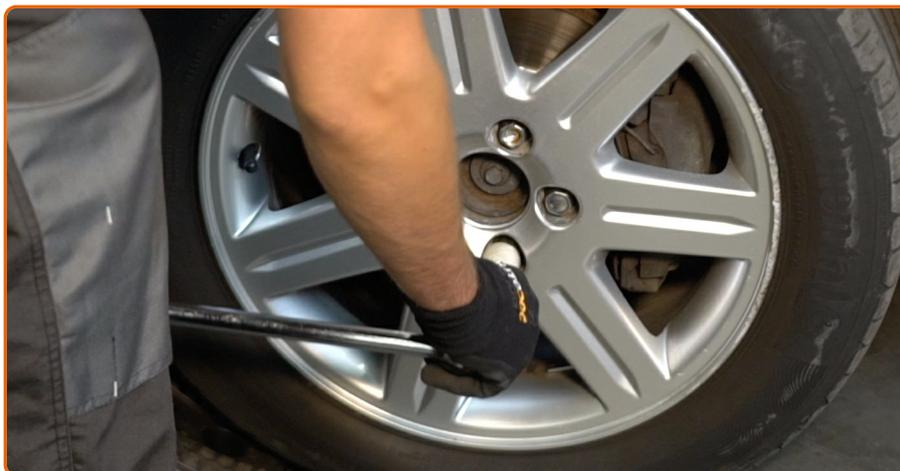
Solte os parafusos de montagem das rodas. Use o soquete de impacto para roda #19.
