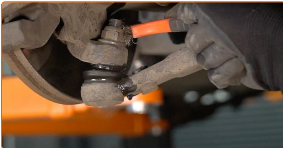
Limpe o fixador que liga a junta esférica à manga do eixo. Use uma escova metálica. Use spray WD-40.
