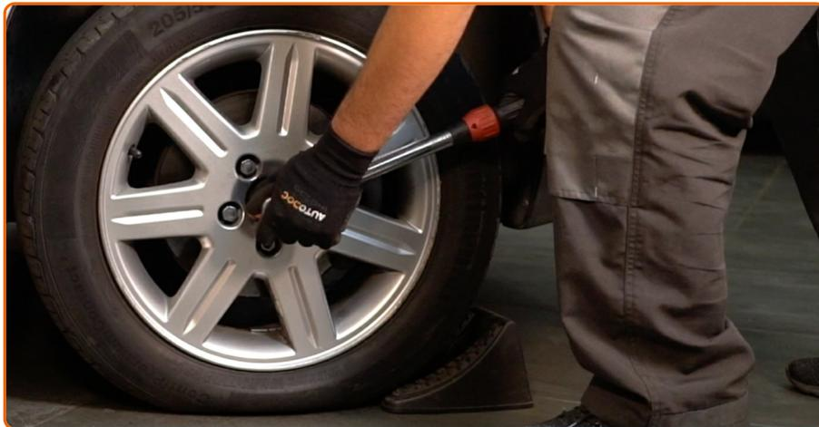
Aperte o parafuso que liga o eixo de transmissão ao cubo de roda. Use uma chave soquete nº 13. Use uma chave de torque. Aperte-o para o torque de 94 Nm.
